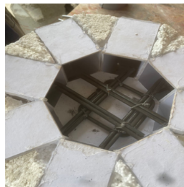
Figura 9. Fase de elaboración del prototipo de ocrápodo con geopolímero
