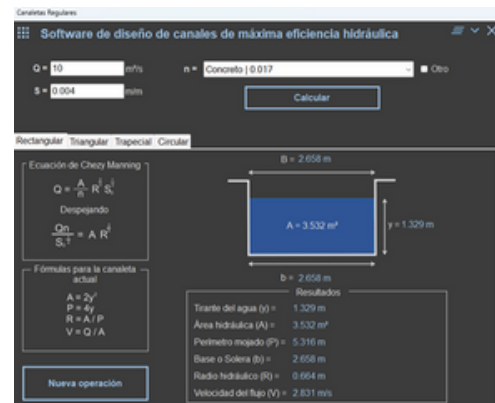
Figura 12. Determinación de las dimensiones de un canal rectangular de máxima eficiencia hidráulica.
