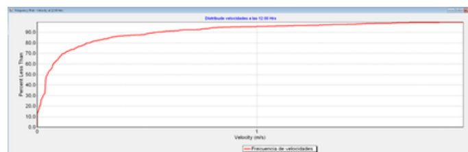
Figura 23. Velocidades en las tuberías del sistema a las 12:00 hrs.
