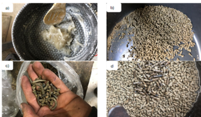
Figura 3. Producción de pellets con aglutinante; a) aglutinante, b) pellets concentración aglutinante 10%, c) pellets concentración 5%, d) pellets concentración 2%.
