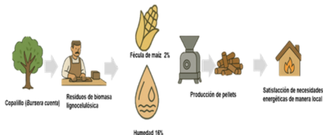
Figura 2. Producción de pellets a partir de residuos de biomasa lignocelulósica para la obtención de bioenergía en la comunidad rural de Tócuaro, Michoacán, México
