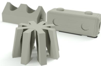
Figura 2. Bloque de concreto "Punta de flecha", bloque de plásticos y octrápodo de geopolímero
