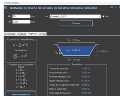
Figura 13. Diseño de un canal trapecoidal de máxima eficiencia hidráulica con relación de taludes de 60°.
