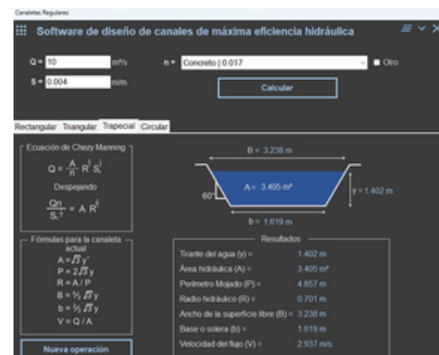
Figura 13. Diseño de un canal trapezoidal de máxima eficiencia hidráulica con relación de taludes de 60°.
